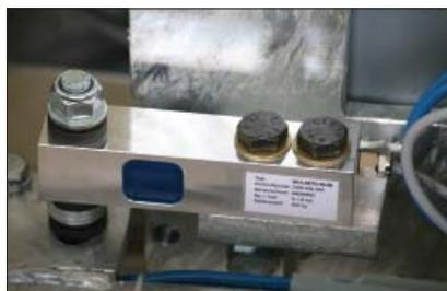
Tutte le misure sono effettuate da un sensore elettronico di qualità del tipo cella di carico. Questo sistema di misura è privo di usura ed assicura rilievi affidabili e accurati delle forze sviluppate.
