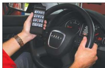
Il telecomando ad infrarossi è un accessorio che può essere utilizzato per controllare le fasi della prova dal posto di guida a completa discrezione dell'operatore, ad esempio avviando la sola prova dei freni o effettuando la prova nella sequenza prescelta.
