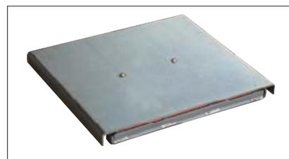
Il prova deriva è stato progettato per verificare la convergenza dell'asse in prova in modo istantaneo. E' necessario semplicemente transitare sopra alla piastra di prova posizionata immediatamente prima del prova sospensioni. Il risultato è acquisito automaticamente e fornisce un valore assimilabile alla convergenza o divergenza dell'asse in prova. Il valore è visualizzato con un campo di misura pari a 0 +/- 20 mm/m.
